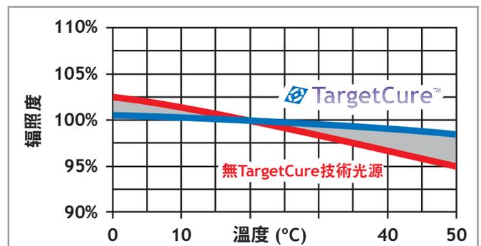
**準確** TargetCure技術通過提供目標輻照度消除過沖現象和平衡時間。這在掃描應用中尤為重要。因為光源在基材上來回運行時需在“開”與“關”兩種狀態間切換，TargetCure技術確保提供正確的能量而無需等待光源達到平衡。
