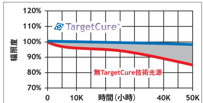
**一致** TargetCure技術在產品正常操作溫度範圍內提供穩定的輸出。這確保了在不同季節甚至日常溫度變化下系統輸出的穩定性。另外由於不必根據環境溫度調整強度節省了操作人員的時間。
